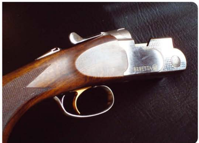
Μονοσκανδάλο με επίχρυση σκανδάλη και επιλογέα στο επάνω μέρος της βάσης, μαζί με την ασφάλεια όπως σε όλα τα μοντέλα της Beretta.
